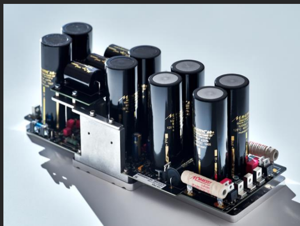
最新モデル「725」搭載の電源部
